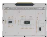
13305 Экспериментальный модуль комбинационных логических схем (5)
